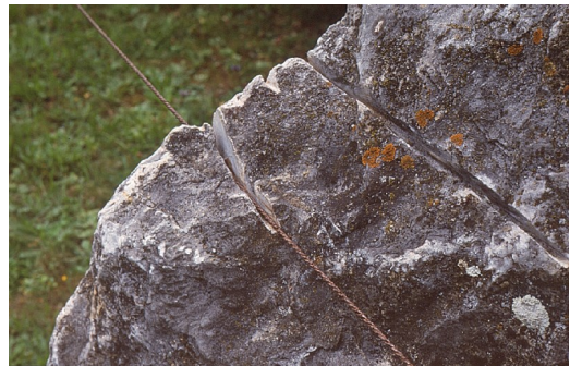
Abb. 1: Die übliche Gewinnungstechnik im massigen Kalkstein der Lahnmarmor-Industrie: Durch die Drahtseil-Sägen entstanden in den Steinbrüchen große, gesägte Wandflächen. Sie geben detailreiche Einblicke in den Fossilinhalt der Riffe.
