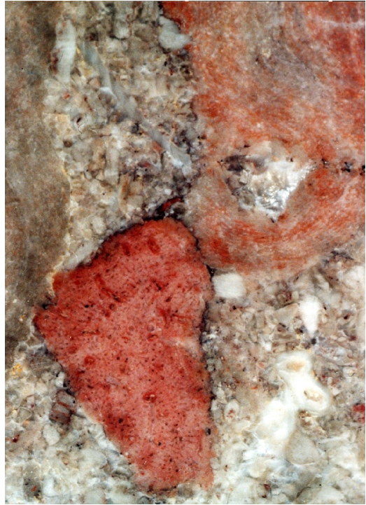
Abb. 6: Die Farbe, besonders de Stromatoporen-Skelette, macht einen großen Teil des optischen Reizes des Lahnmarmors aus. Sie geht im Lahnmarmor auf fein verteiltes Eisenoxid zurück. Vermutlich wurde das Eisen-Pigment im Sediment und in vielen Fossilresten durch Bakterien gebildet. Manche Stücke sind sehr intensiv rot gefärbt, andere (links am Rand) überhaupt nicht.
